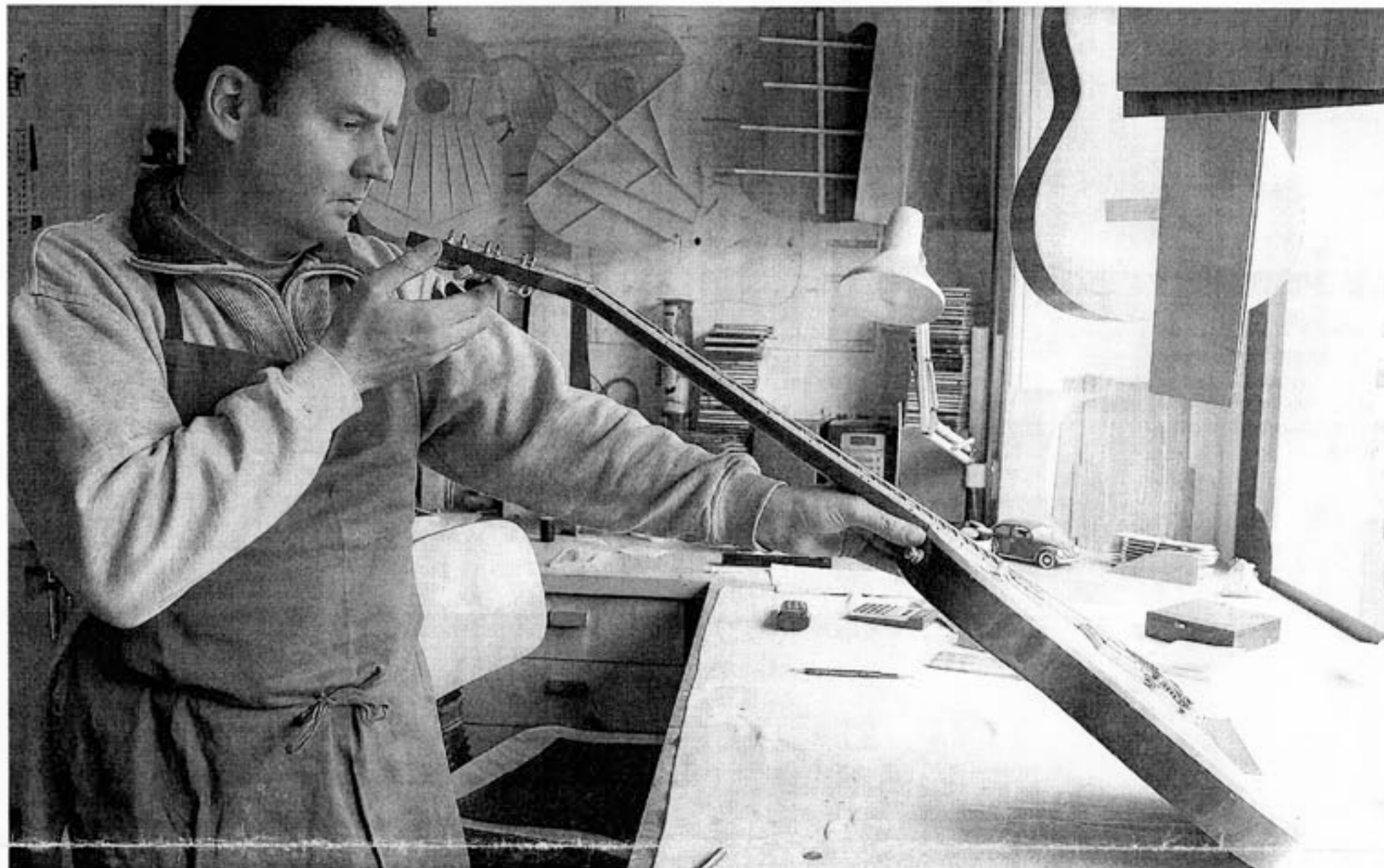
Präzision gefragt: Markus Bissig kontrolliert die Krümmung des Gitarrenhalses.
